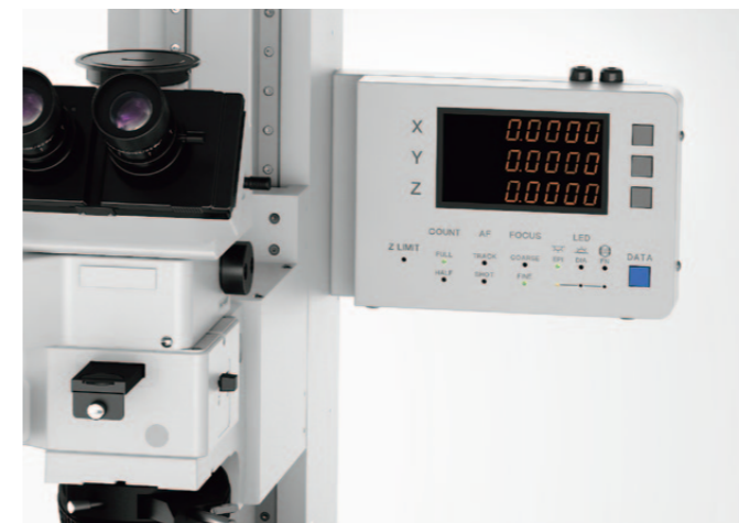
计数器安装在镜架上
