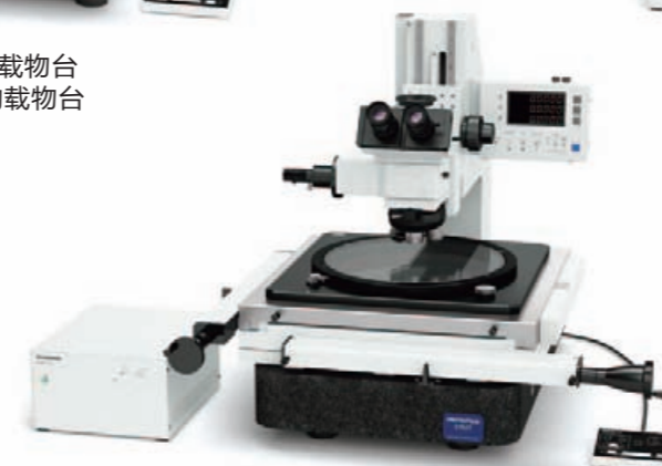
STM7-LF 配备300mm × 300mm 的载物台
