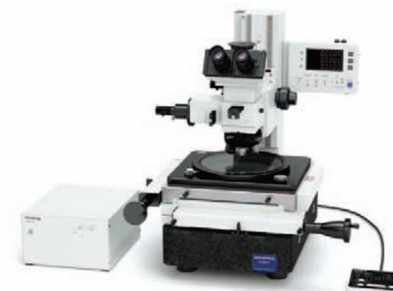
STM7-MF 配备200mm × 200mm 的载物台
